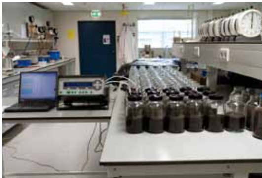
Meting ammoniak- en lachgasemissie onder gecontroleerde omstandigheden; bodemonsters bouwland.
