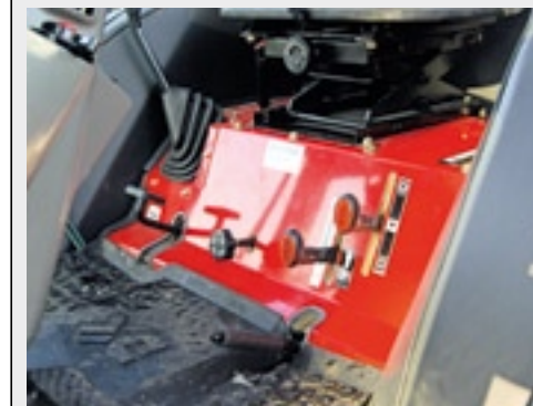
Onder de stoel zitten hendels voor de handrem, pto, 4wd, hefsnelheid en differentieel.
