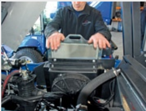
Het rooster dat voor de oliekoeler zit om grove delen op te vangen, bedient wat zwaar.
