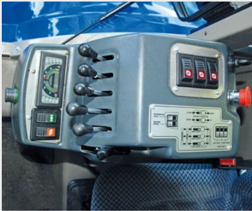
Op het zijconsole kun je de gehele machine bedienen, temperatuur en ventilatie bedien je op een console in het dak. De rode knop is een noodstop.
