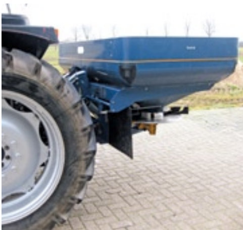
Spatlappen achter de trekkerbanden voorkomen extra vervuiling van de strooier.
