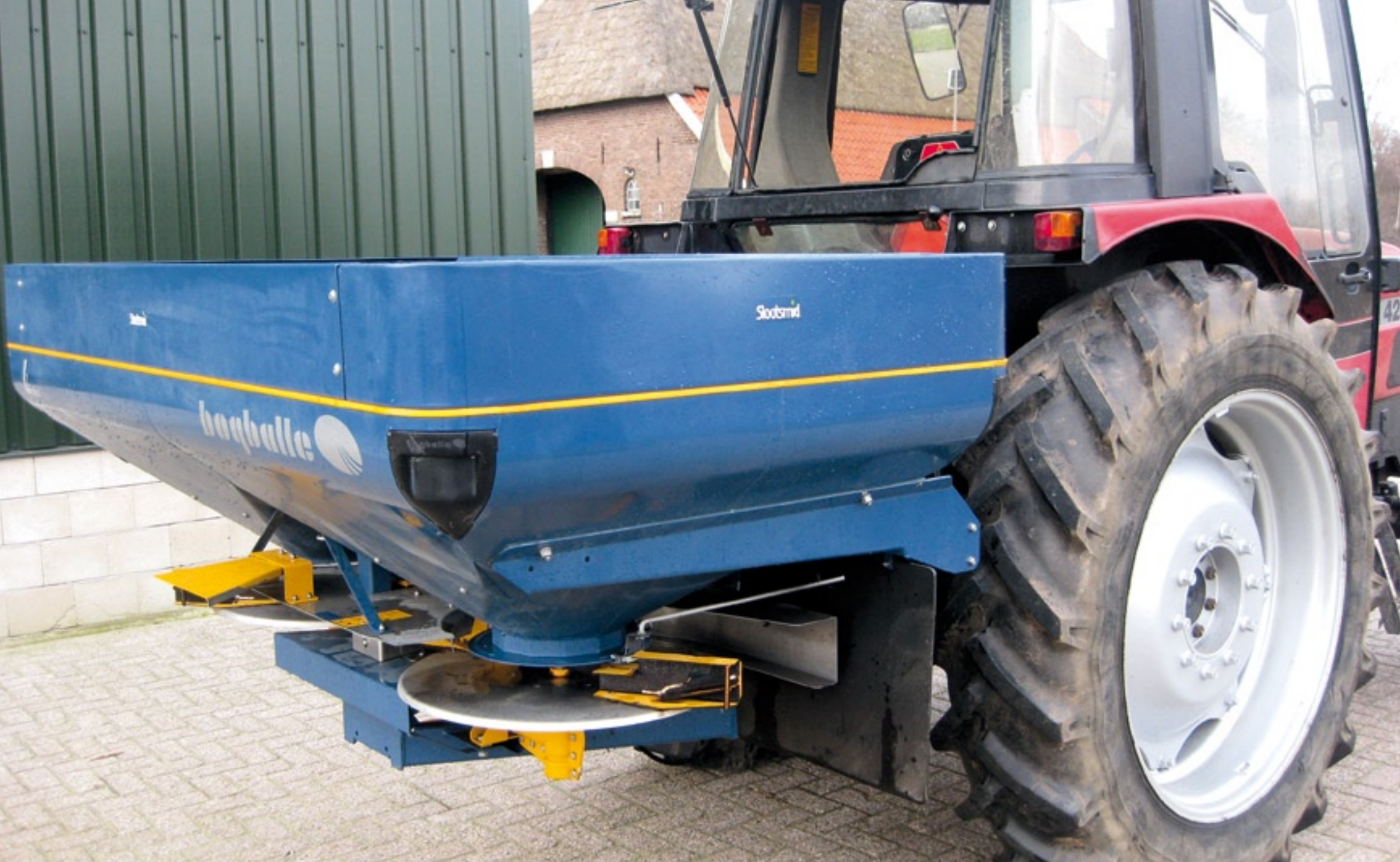
Met een hendel achterop tussen de trechters schakel je de draairichting van de rechterschijf om.
