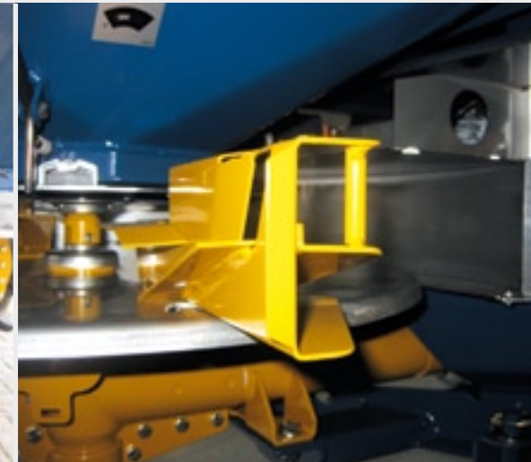
De speciaal ontworpen schoepen zijn ontworpen voor grens strooien en volvelds strooien. Je draait alleen de draairichting van de schijven om.
