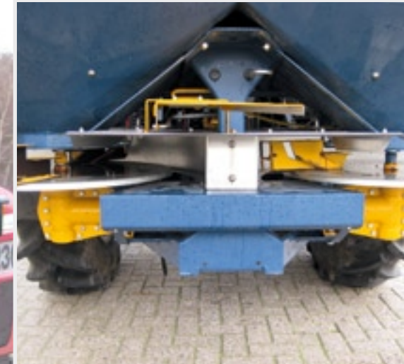
Met een hendel achterop tussen de trechters schakel je de draairichting van de rechterschijf om.
