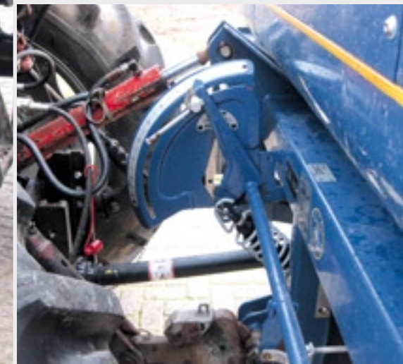
De strooier hangt dicht op de trekker. Goed voor de gewichtsverdeling, een nadeel bij aankoppelen.
