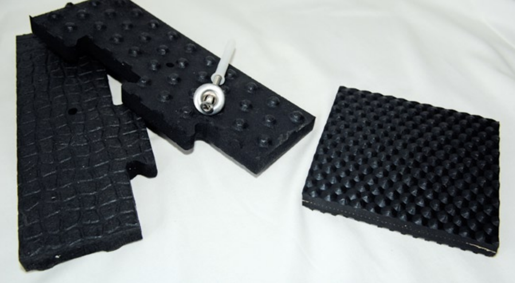
▲ Twee keer een rubber mat. Links de onder- en bovenkant van Kraiburg's Kura F, een mat die als puzzelmat wordt geleverd. Met de bijgeleverde 8 cm lange spijkerpluggen leg je de mat vast. Rechts de Cowhouse Dairyfloor mat, een mat op een rol met een koordlaag die ervoor zorgt dat de rek minimaal is.
