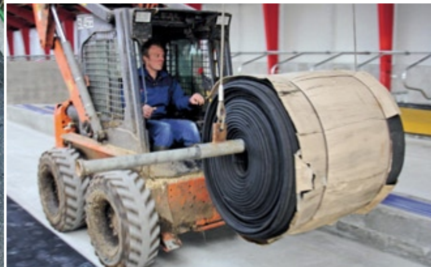
▲ Bij het leggen van een rubbermat op rol kun je de hulp van een shoveltje of een schranklader goed gebruiken. De rol is immers zwaar.
