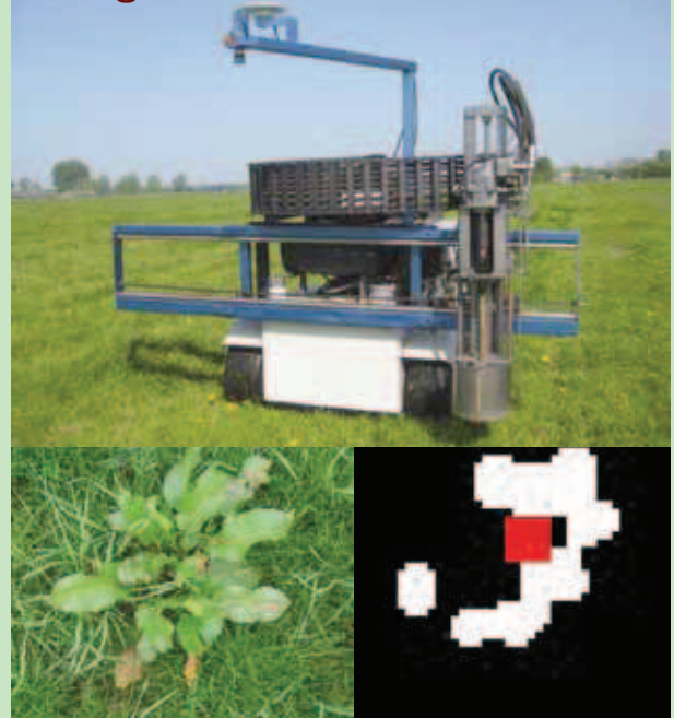
Zuringplantherkenningssysteem project Ruud, met linksonder een zuringplant in grasland en rechtsonder beeldanalyse van de zuringplant: wit is plant, rode stip is positie penwortel.
