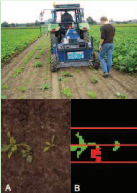
Aardappelopslagdetectiesysteem STW-project Nieuwenhuizen, met rechtsonder beeldanalyse van foto A: suikerbietplanten op foto B zijn groen en aardappelplant is rood.
