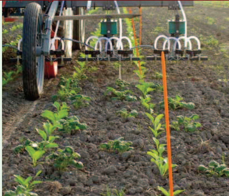
Sensorgestuurde plantgerichte bestrijding van aardappelopslag in suikerbieten met Weed IT prototype, Lelystad 2008.
