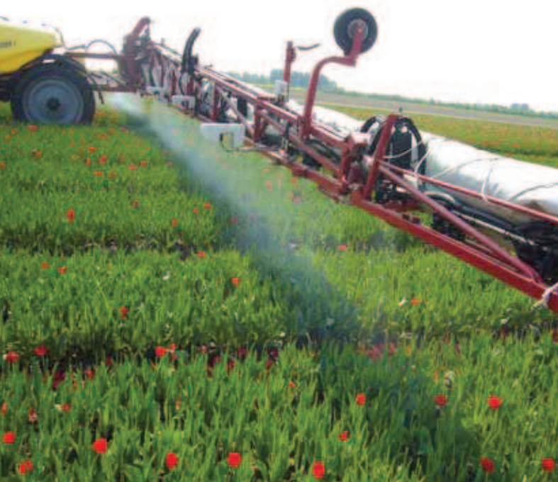
Sensorgestuurde plaats specifieke dosering van fungiciden in tulp met SensiSpray prototype, Lelystad 2009.
