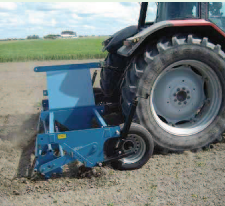
Wortelsnijder voor de ondergrondse bestrijding van meerjarige onkruiden.
