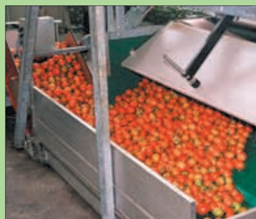
In de losunit gaat de zijkant van de oogstwagen open en rollen de tomaten eruit.
