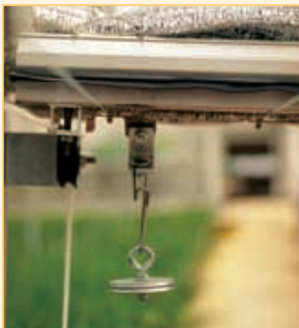
De tuimelaar haakt achter het spant. Bij het sluiten van het scherm wordt zo het eerste doek (aan de zijde van het spant) op zijn plek gehouden, terwijl het eerste doek (aan profielzijde) wordt gesloten.
