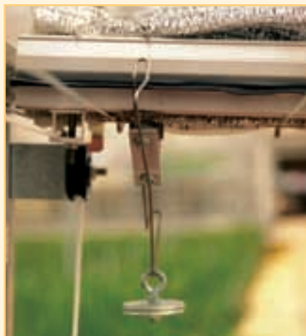
De tuimelaar haakt achter het profiel. Bij het sluiten van het scherm wordt het eerste doek ontvouwen, terwijl het doek aan de profielzijde tegen het profiel dicht gevouwen blijft.
