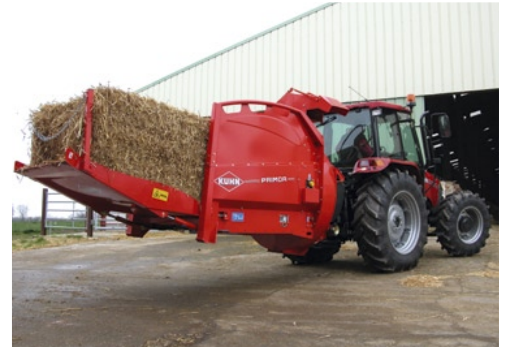
Niet het motor- maar het hefvermogen is bij een gedragen stroverdeler vaak de beperkende factor. Dit geldt naast de trekkeraanbouw ook voor machines aan verreikers en shovels.
