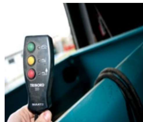
▲ Met de afstandsbediening stel je de positie van de kantstrooi-inrichting in.
