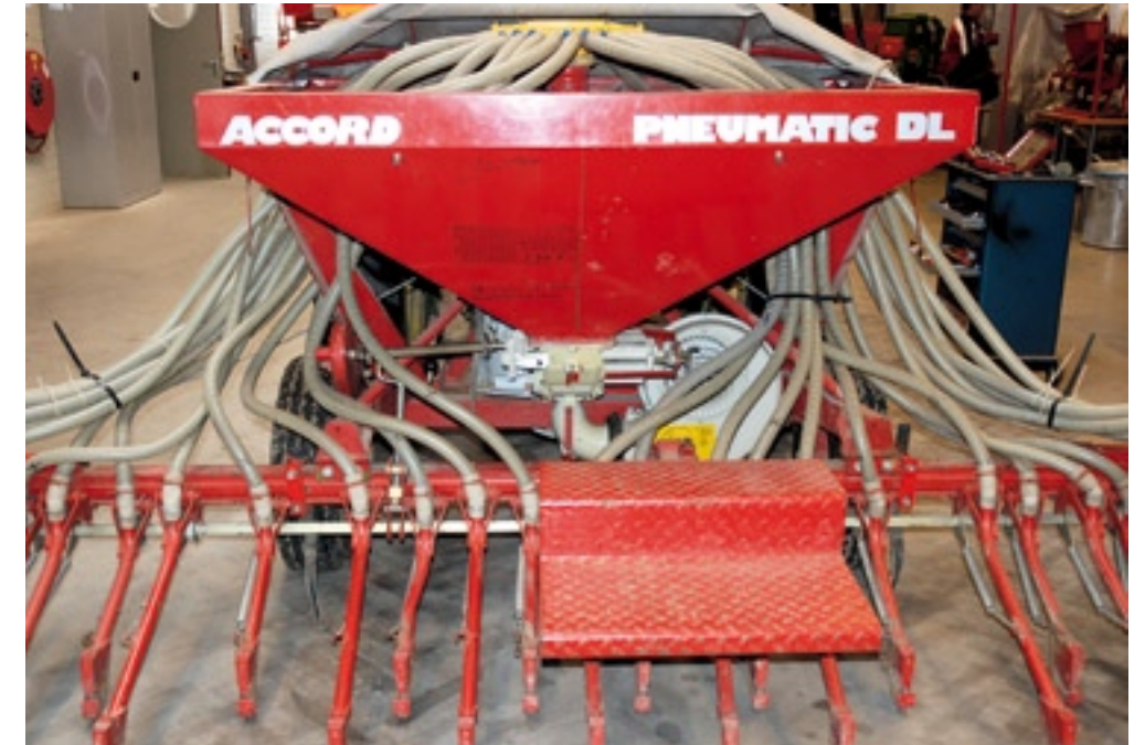
▲ Een pneumatische zaaimachine is een kleine machine in transport, maar heeft een grotere werkbreedte.
