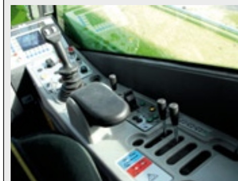
▲ De kruishendel voor het heffen/dalen en het kantelen van de bak neemt een centrale plaats in. Rechts zitten de hydrauliekhendels.
