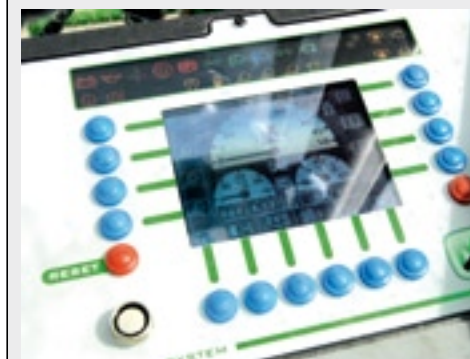
▲ Combinatie van elektronisch dashboard en multifunctioneel bedieningsscherm.
