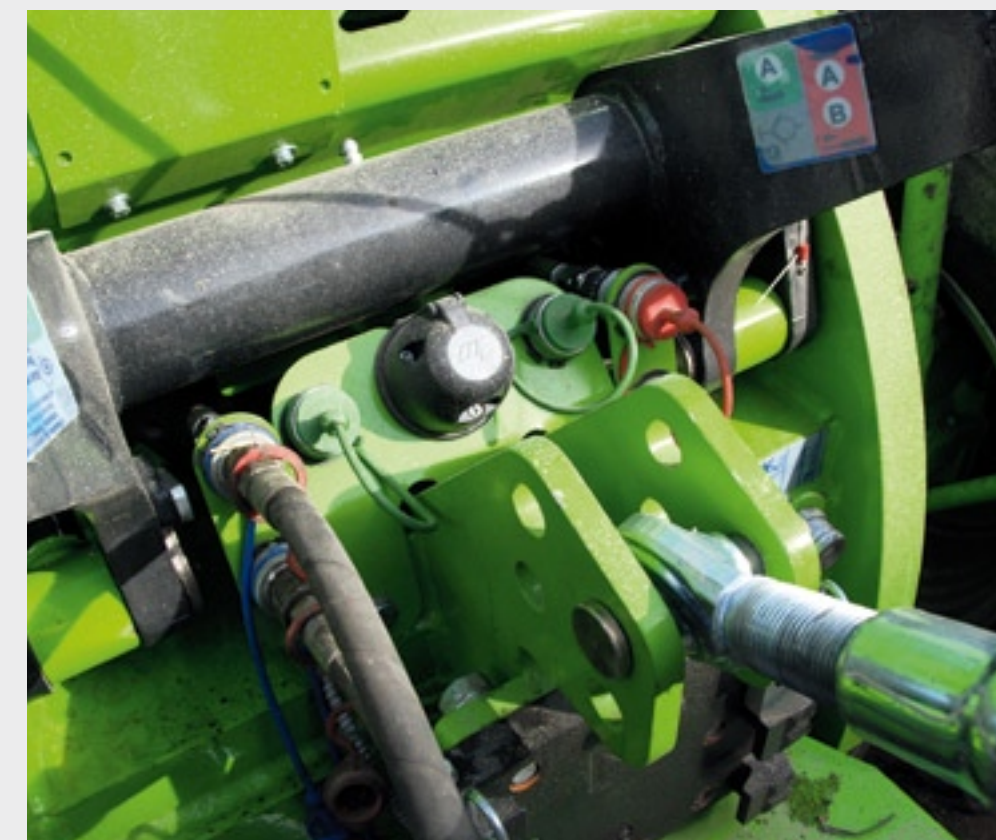
▲ De topstang is op vier posities te bevestigen en praktisch op te bergen. Olie en druk voor de hydrauliek zijn in voldoende mate aanwezig. Het ventiel (rode dop) voor de beremming van volgwagens is standaard.
