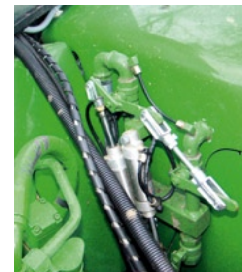
▲ De luchtgestuurde kogelkranen achterop de trekker.
