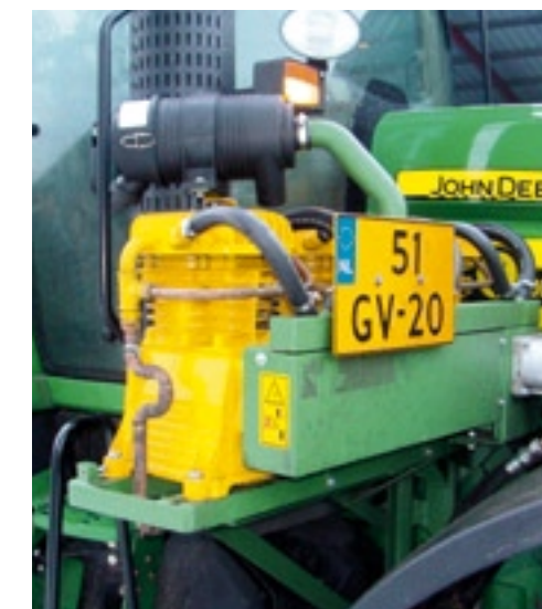
▲ De compressorunit rechts voor de cabine.
