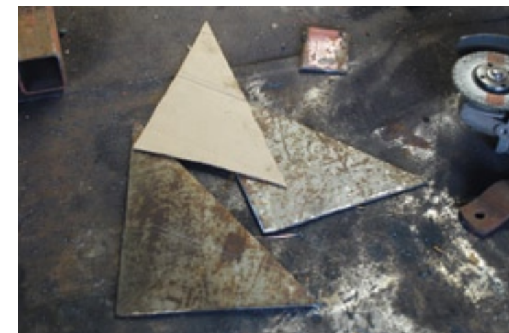
▲ Aan de blazer maak je platen van metaal of aluminium, zodat de uitlaatlucht via een pijp en slang loopt. Dun metaal kun je zelf lassen en trilt niet zo snel kapot. Voor het gemak kun je eerst de vorm van de plaat van karton maken zodat je niet meteen het metaal hoeft te gaan knippen.
