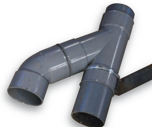
▲ De luchtsnelheid verlagen voorkomt opwaaierend stof. Dit kan door de diameter van de uitlaat te vergroten of met een T- of Y-stuk de uitlaatstroom op te splitsen. De lucht heeft dan een grotere omtrek om de kap te verlaten. Een stuk oude binnenband of brandweerslang doet goed dienst als lamellen.
