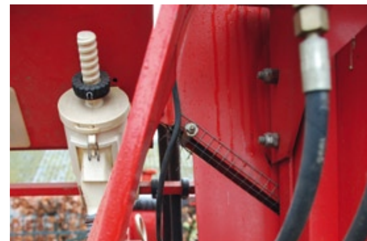
▲ Importeurs leveren een deflectorset. Je krijgt dan een compleet passend pakket voor je eigen merk en type zaaimachine dat je zelf aan de blazer moet monteren. Ben je echter een beetje handig, dan kun je ook zelf de aanpassing aan de uitlaat (zie stuk gaas) van de blazer maken.
