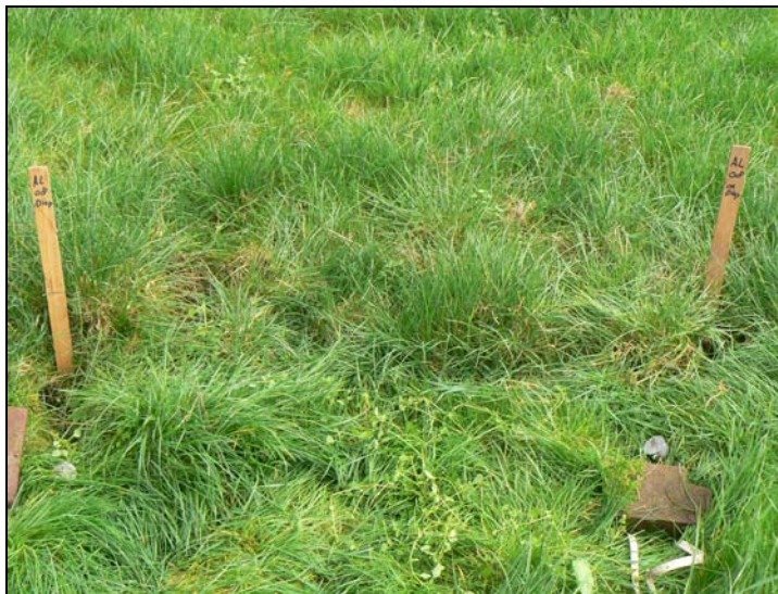
Figuur 3.18 Ligging van twee door Alterra geplaatste grondwaterstandsbuizen (AL08b (ondiep) en AL08a (diep) op een locatie met een storende laag (lössleem) in het bodemprofiel
