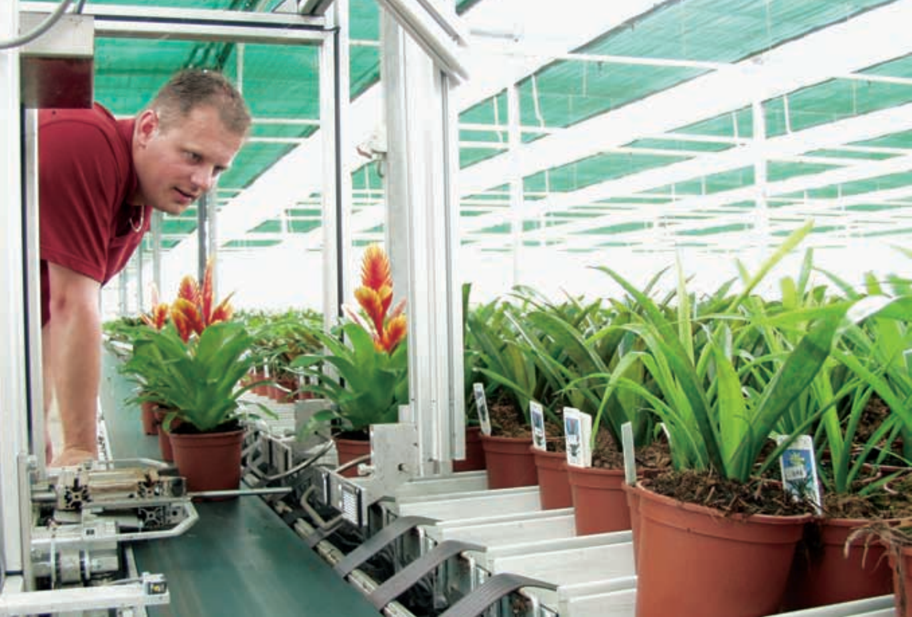
In de goten liggen banden waardoor de planten naar elke gewenste plek kunnen worden getransporteerd.
