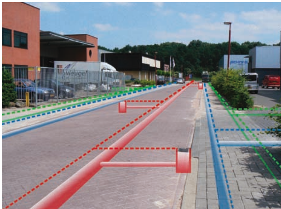
Afb. 2: De ligging van kabels en leidingen, zoals te zien door een augmented reality-bril.
