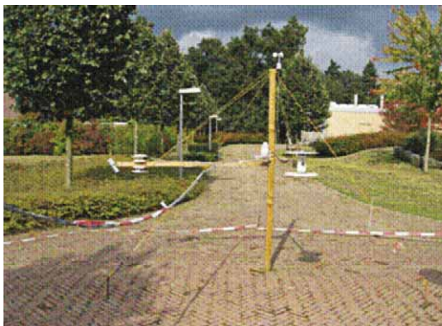
Weerstation uitgerust met stralings-sensoren, thermometers en een windmeter.
