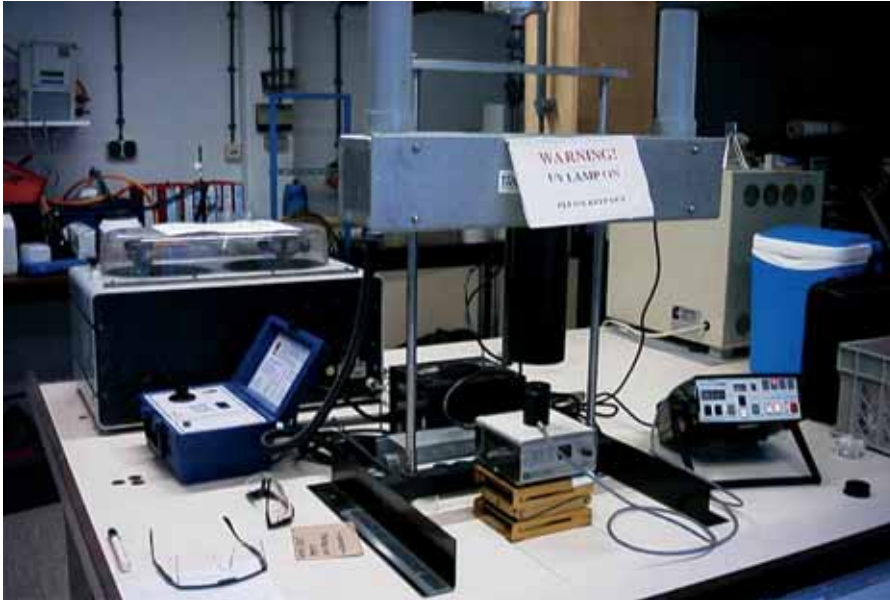
Een 'collimated beam'-apparaat voor UV-inactivatie.
