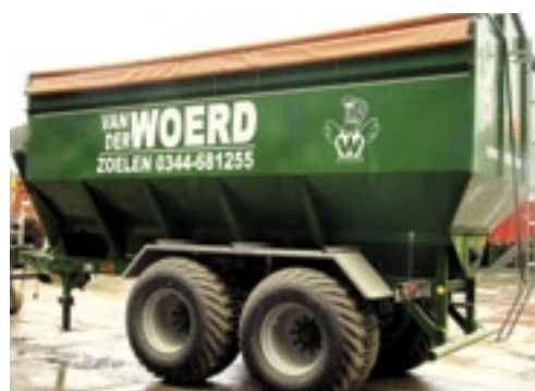
▲ Het dekzeil kan met een eenvoudige handeling worden afgerold, zodat het product snel in veiligheid gebracht kan worden bij onverwachte weersomstandigheden.
