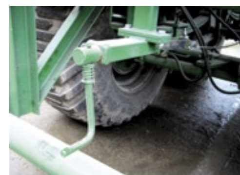
▲ De instelling van de remkracht kan eenvoudig met de hand worden aangepast.
