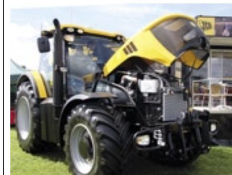
▲ Onder de knalgele motorkap ligt een Cummins zescilinder van 164 kW (223 pk).
