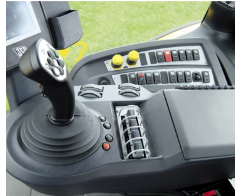
▲ De console is overzichtelijk. De powershift heeft 24 schakelmogelijkheden vooruit, verdeeld in vier groepen. Beugels over de knoppen dichtbij de joystick voorkomt onverwacht inschakelen.
