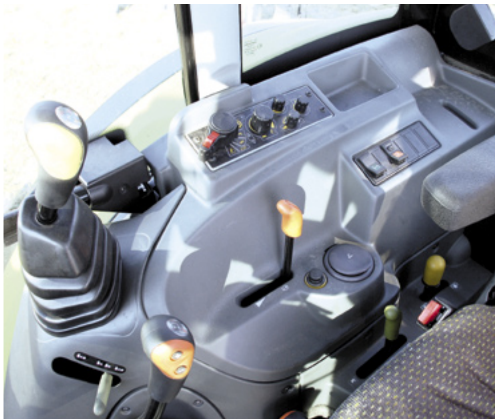
▲ De optionele kruishendel voor hydrauliek is linksonder vergrendeld tegen per ongeluk bedienen bij het uitstappen. Met de knopjes op de versnellingspook bedien je de koppeling en de powershift.
