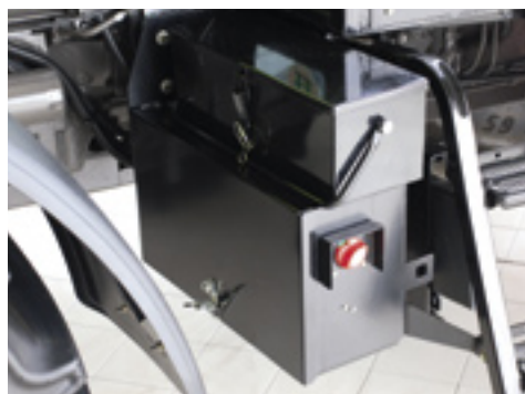
▲ Op de accubak zit een stevige gereedschap-kist. De brandstoftank zit rechts.
