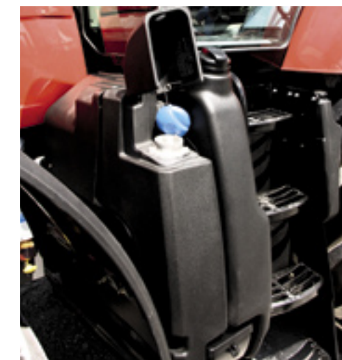
▲ Bij de MF 8690 zit de tank voor AdBlue naast de brandstoftank. De AdBlue tank is 52 liter groot.
