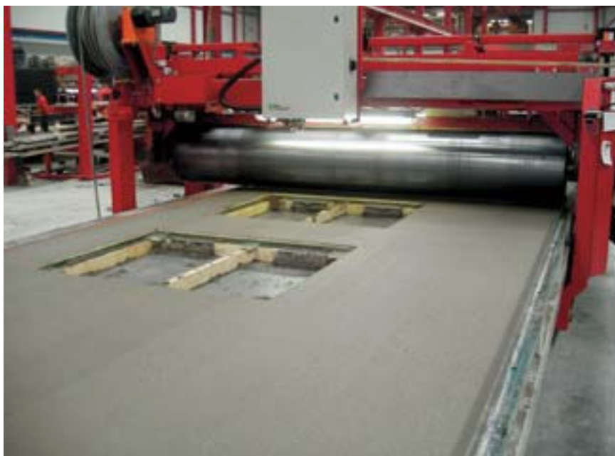
De fabricage van geprefabriceerde betonelementen
