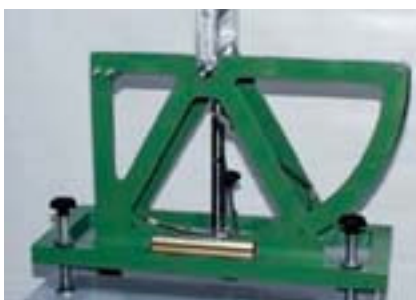
Stroefheidsmeter van Leroux om de stroefheid van een oppervlak te bepalen (NEN 2873).
