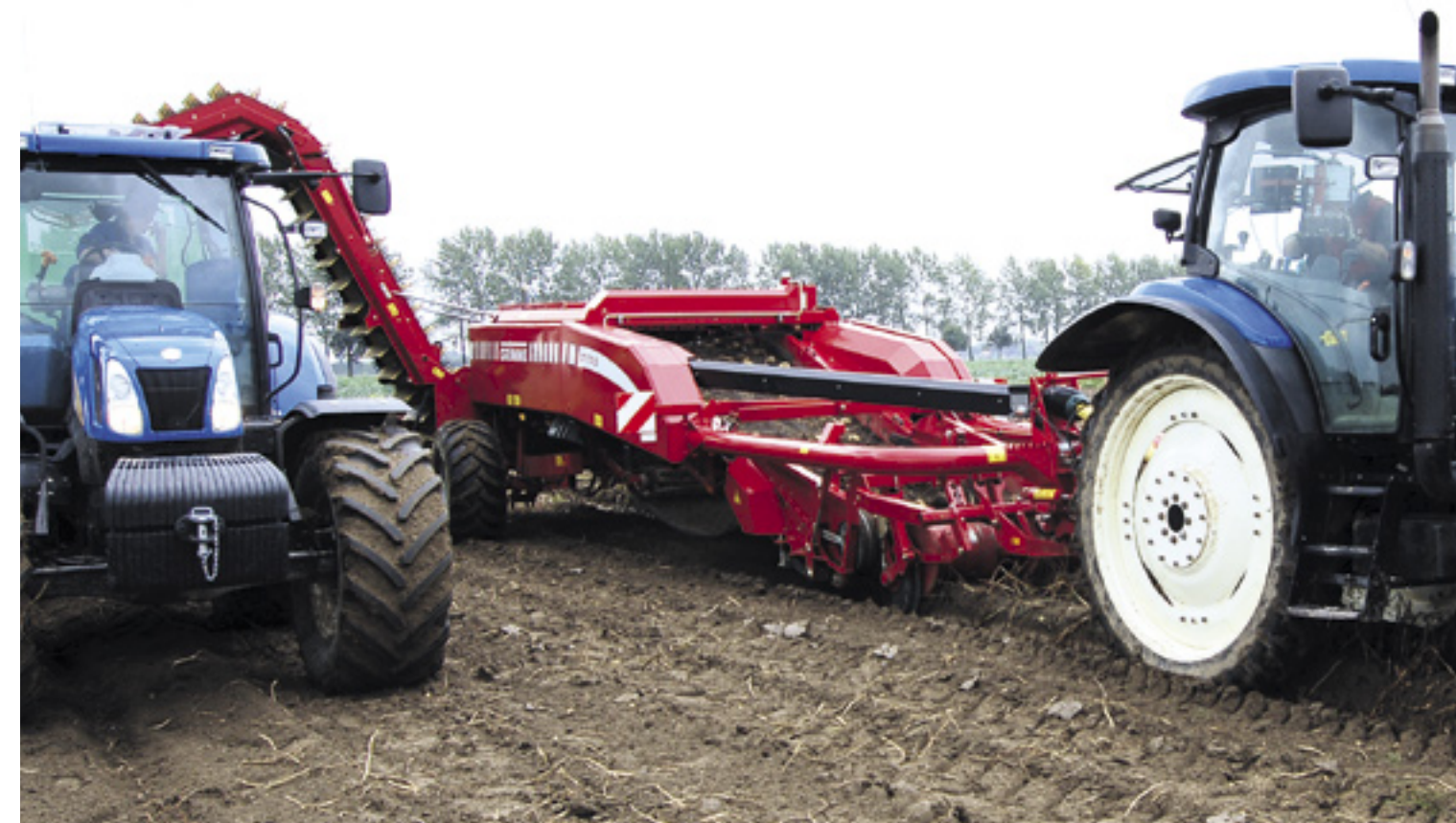
▲ Bij de Grimme GT 170 S zitten achter de axiaalrollen de rollen van het multisepsysteem.
