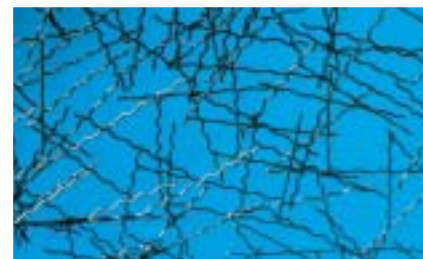
De staalvezels hebben een golf lengte van 8 mm
