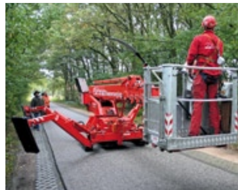
Bij verplaatsen klap je de stempels iets omhoog. De machine moet wel ingeklapt zijn.
