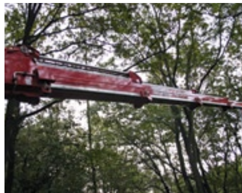
De mast bestaat uit vier delen die allen gelijktijdig uitschuiven.
