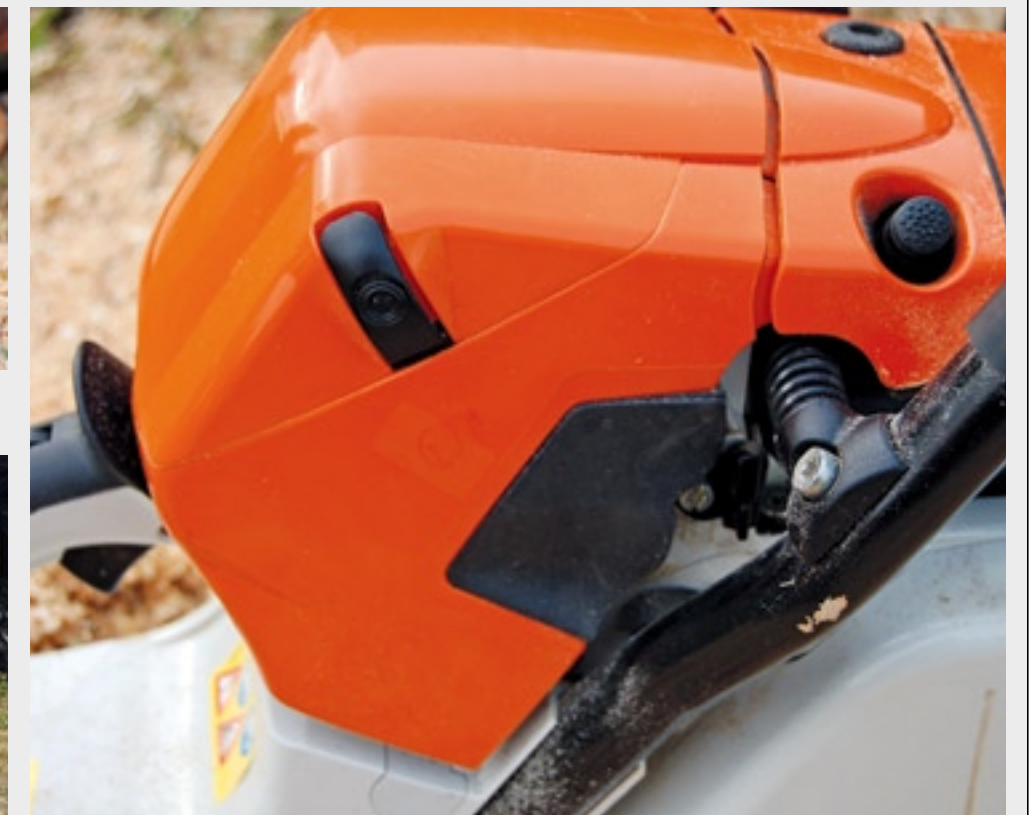
Bij de 441 C-M zitten er geen gaten meer voor de afstelling van de lage en hoge toeren. M-Tronic regelt automatisch de optimale afstelling, zowel bij stationair als bij volgas.
