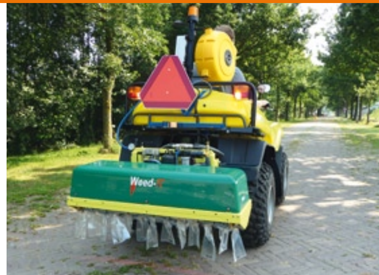
Een testbaan van ruim 100 meter had gemiddeld 3 procent groenoppervlak. De verspoten hoeveelheid vloeistof is bepaald via het opvangen van vloeistof in zakjes of door afname in het reservoir. Onkruidstrijkers hadden het laagste verbruik, daarna de sensorgestuurde technieken en daarna de schijfvernevelaars.
