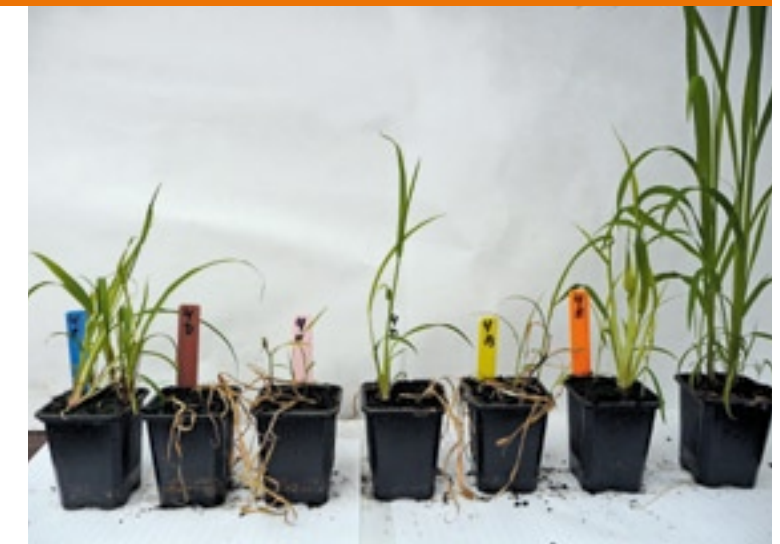
Dosering 0,5 liter Roundup Evolution per hectare. Rechter pot onbehandeld, blauw label Weed-IT MKII, bruine Mankar Unima City, geel Laag Volume Spuit, oranje Weedseeker (65,01 dop) en roze Weedseeker met 40.0067 dop. Bij gelijke doseringen werken schijfvernevelaars het beste.
