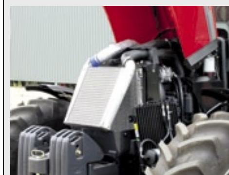
▲ Het pakket koelers goed reinigen vraagt sleutelwerk en tijd.
