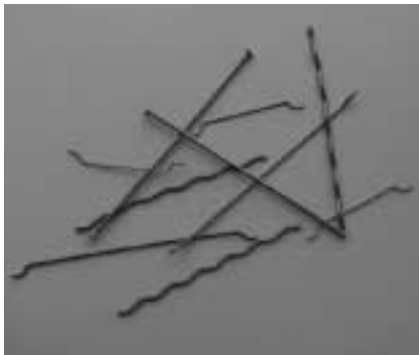
Staalvezels zijn er in vele verschijningsvormen. Links enkele voorbeelden van Eurosteel, Dramix, Twincone en rechts vezels die zijn verlijmd met lijm die tijdens het mengen van de specie oplost
