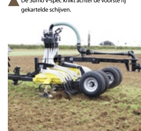
▲ De Aerway combinatie messeneg/mestinjecteur met sleepslang.
