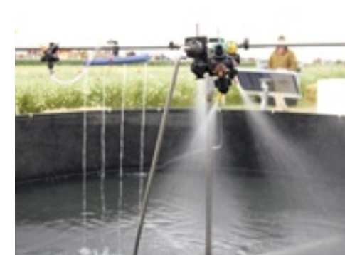
▲ Billericay, een enkelvoudige schuinstaande spleetdop voor onder een spuitkap.
