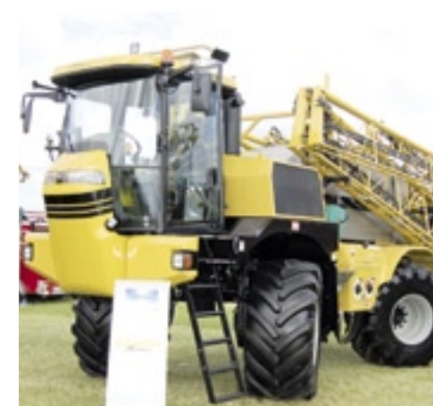
▲ De Chafer Challenger Rogator 618 kan zo nodig in hondengang rijden.
