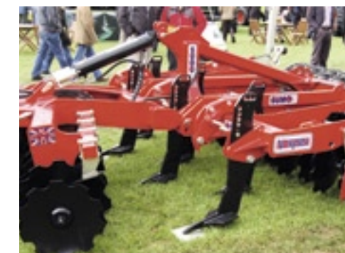
▲ De Sumo V-spec knikt achter de voorste rij gekartelde schijven.
