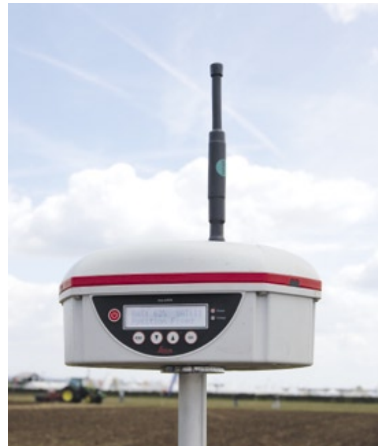
▲ Het Mojo-RTK-baken van Leica Geosystems met daarnaast de beide antennes op het dak van de trekker.
