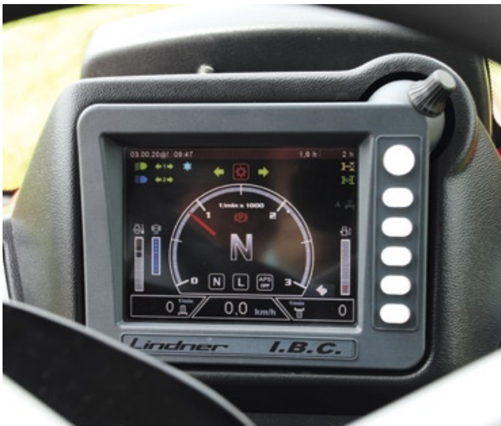
▲ De IBC (intelligente boordcomputer) die Lindner samen met Bosch Rexroth ontwierp, toont alle informatie die je op een dashboard verwacht. Maar er is meer. Je kunt ook servicegegevens opvragen.
