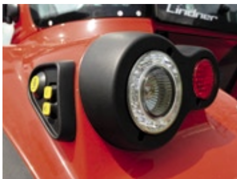
▲ De Geotrac 124 heeft led-verlichting en een afstandsbediening voor de hef en aftakas.
