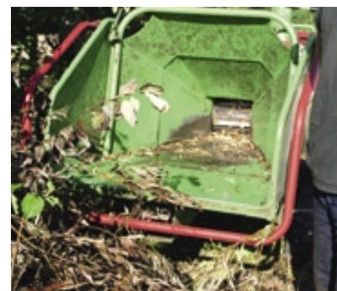
De invoer is klein maar heeft een grote capaciteit doordat hij snel draait en snel weer op gang is.
