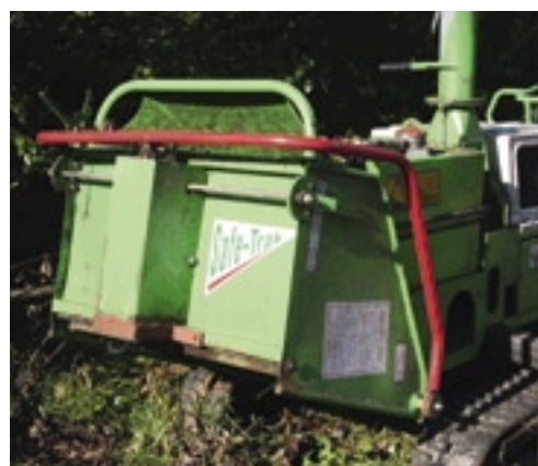
De invoer is opklapbaar voor transport. Voor smalle doorgangen kun je hem demonteren.
