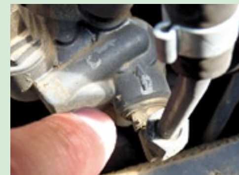
Kijk goed welke leidingen de aanvoer- en retourleidingen zijn. Deze dienen gescheiden per kamer aangebracht te worden. Vaak is dat op de brandstofpomp al aangegeven met een duidelijke pijl. De leidingen dienen opnieuw afgemeten te worden en te zijn voorzien van de juist passende tules en bajonetbouten met afdichting. Schoon en netjes werken is hierbij cruciaal.
