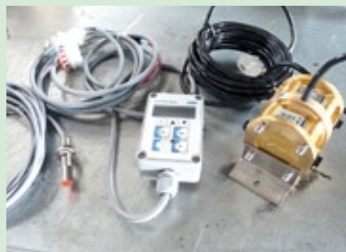
De opbouwset van Hansenhof/WTK bestaat uit drie hoofdcomponenten. Een volumemeter met geïntegreerde elektronica, een kleine monitor om de gegevens af te lezen en een toerental-sensor. Op verzoek is ook een sensor op de hef-inrichting te bouwen voor hectaremeting. Om het meetinstrument op te bouwen dient schoon en netjes gewerkt te worden. Er mag geen vervuiling in de leidingen komen.
