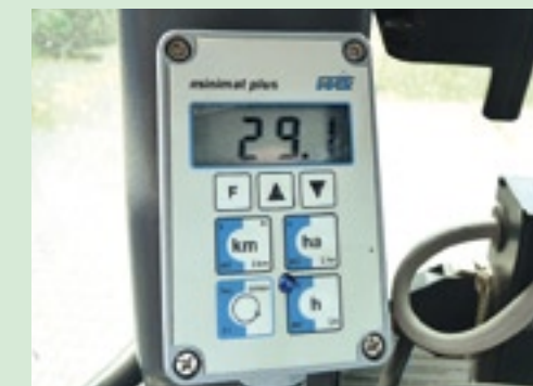
Het display is compact, overzichtelijk en eenvoudig te bedienen. Achtereenvolgens zijn de liters per uur, liters per hectare, het totaal verbruik en (afhankelijk van de uitvoering) ook een toerental af te lezen. Dit zou ook een astoerental van een werktuig kunnen zijn. Iedere 30 seconden wordt het verbruik per uur geactualiseerd.
