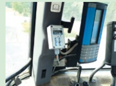
De monitor komt op een duidelijk zichtbare plaats in de cabine, nabij de bestuurder. Voor stroomvoorzorging wordt het systeem aangesloten op een deugdelijke stroombron van 12 volt. Omdat het systeem werkt op volumemeting is geen hoog ampèrage vereist. Voor de rijsnelheid kun je zowel een wielsensor toepassen als gebruik maken van de beschikbare meetwaarden van de trekker. Dit geldt ook voor de motortoerentalsensor.
