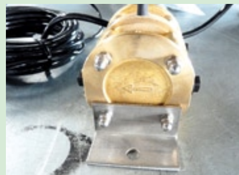
De volumemeter heeft twee kamers. Eén kamer voor de aanvoer met twee aansluitingen en één kamer voor de retour met twee aansluitingen. De waarden worden met elkaar verrekend en bepalen het verbruik. Let hierbij goed op de juiste stroomrichting en dat de juiste leidingen op de juiste kamer worden aangesloten.
