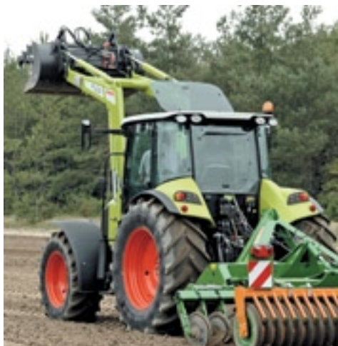
▲ De hef van de nieuwe Arion tilt standaard 5,2 ton; tegen meerprijs is dat 6,5 ton.
