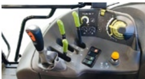
▲ De pook links is het handgas met daarop knopjes voor de transmissie.
