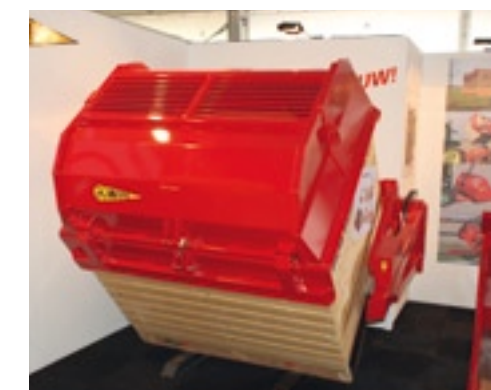
▲ Ploeger lanceerde de meerrijige wagenrooier AR-4W. In Emmeloord rooide deze als vierrijer met twee tweerijige rooischaren en -matten overgaand in een brede zeefketting. De machine is ook leverbaar als drierijer voor 90 cm rijenafstand en dan met drie afzonderlijke rooischaren. Daarmee speelt Ploeger in op de maximaal toegestane breedte voor transport over de weg. Met loofklapper is de machine ongeveer 15 meter lang. Onder de machine zit een breed rupsonderstel dat hydraulisch zwenkbaar is over ongeveer 20 graden. Door tegenstuur blijft de draaicirkel klein. Opvallend zijn ook de grote, hydraulisch aangedreven schijven aan beide kanten van de rug.
