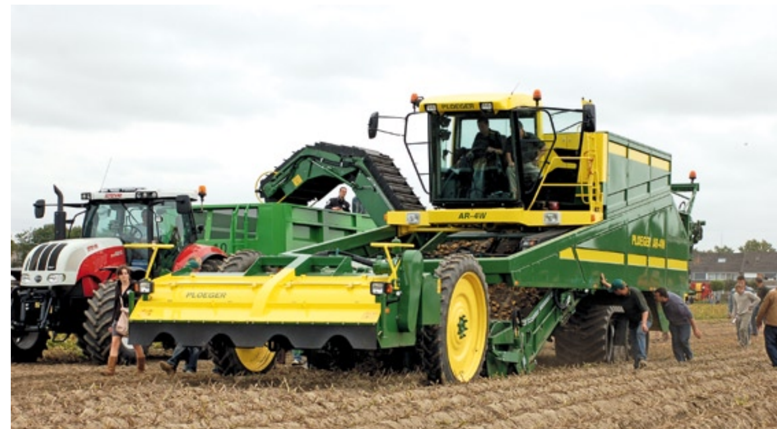
▲ Ploeger lanceerde de meerrijige wagenrooier AR-4W. In Emmeloord rooide deze als vierrijer met twee tweerijige rooischaren en -matten overgaand in een brede zeefketting. De machine is ook leverbaar als drierijer voor 90 cm rijenafstand en dan met drie afzonderlijke rooischaren. Daarmee speelt Ploeger in op de maximaal toegestane breedte voor transport over de weg. Met loofklapper is de machine ongeveer 15 meter lang. Onder de machine zit een breed rupsonderstel dat hydraulisch zwenkbaar is over ongeveer 20 graden. Door tegenstuur blijft de draaicirkel klein. Opvallend zijn ook de grote, hydraulisch aangedreven schijven aan beide kanten van de rug.
