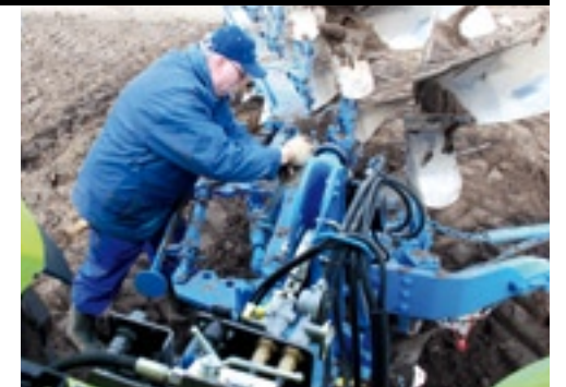
▲ Met het kleine ballastblok in de fronthead is de trekker erg licht en de voorwielen zoeken daarvoor spoor. Ook het verlagen van de bandenspanning heeft invloed op de treklijn van de trekker en dus ook op de ploeg. De optimale treklijn aan de ploeg is hierdoor aangepast.
