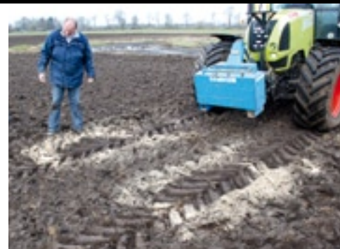
▲ Het opmeten van contactoppervlakte van de banden. Kalkpoeder laat het profiel van de band duidelijk zien. De oppervlakte nam na het aflopen van de band toe van 1,62 m 2 naar 2,60 m 2 . Dit is ruim 60 procent meer bandoppervlakte. De band spoorde tevens 2 cm minder in. Hierbij was de grond los en zanderig.
