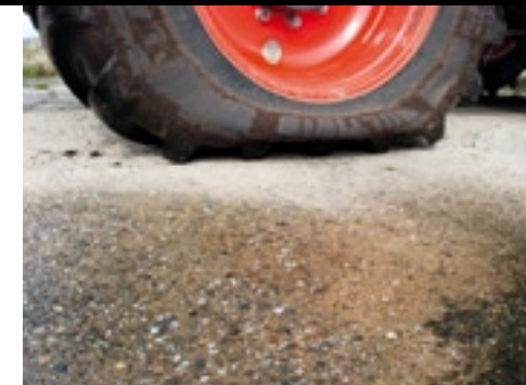
▲ Na de eerste twee metingen lieten we de bandenspanning aflopen. De spanning is berekend naar een maximumsnelheid van 30 km/h. Nadat we de ploeg lieten zakken op een bult grond, kwamen er bij de voorbanden bijna vijf nokken aan de grond; voorwaarts trekkraft en trekkrachtregeling doen veel met bandenspanning.
