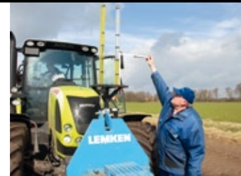
▲ Na het ploegen van de 108 meter is het aantal cm onttrokken brandstof eenvoudig op te meten. Het verschil in brandstofverbruik met deze combinatie is vergelijkbaar met andere; het merk trekker en ploeg hebben op indexcijfers geen invloed.
