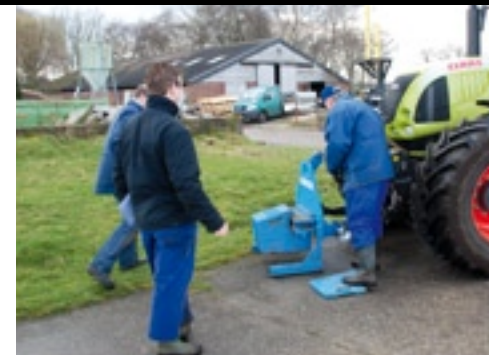
▲ Door het gewicht in de fronthead met ruim één ton te verhogen naar 1.640 kg werd de last op de vooras verhoogd van 1.300 kg naar 2.850 kg. De last op de achteras daalde daarmee met 400 kg naar 7.900 kg. De gewichtsverdeling op de vooras verdubbelde van 14 naar 28 procent, op de achteras daalde het gewichtspercentage van 86 naar 73 procent.
