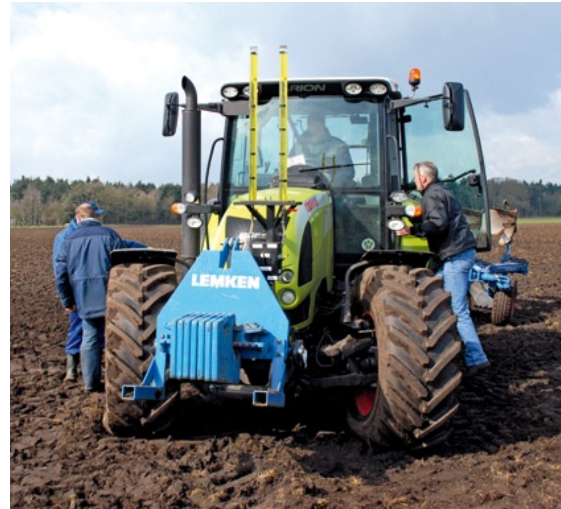
▲ Door te ploegen met een frontgewicht van 1.640 kg aan de trekker en de bandenspanning te verlagen van 2,0 naar 1,2 bar achter en van 1,6 naar 0,4 bar voor, is het brandstofverbruik met 21 procent gereduceerd.
