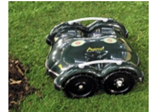
Ambrogio robotmaaier met sensoren.
