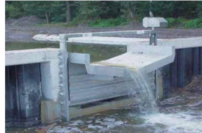
Figuur 1.1. Meetstuw. De hoogte van de overstortende golf wordt precies geregistreerd en is een maat voor de hoeveelheid water die de beek afvoert per tijdseenheid (het debiet). In bovenstaande foto stort er maar een klein golfje over (gemeten van golfkruin tot bovenkant stuw slechts enkele centimeters hoog), het debiet is dan een halve emmer (5 liter) per seconde. De meting is continu en online, en wordt op kantoor afgelezen. Ook de stuwhoogte kan vanaf kantoor worden ingesteld.
