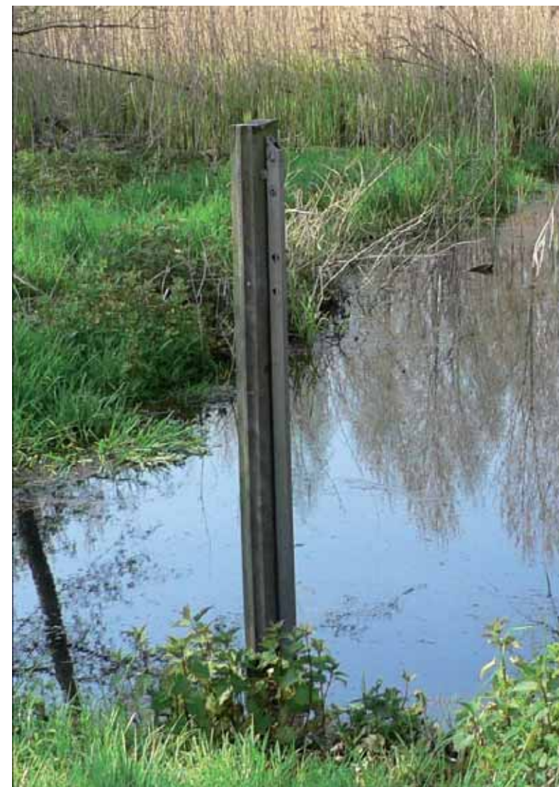
Figuur 3.8.1. De 'paal' in het water is een zogenaamde water-L in de Eckeltsebeek. Deze meet continu het peil in de beek en slaat deze op in een datalogger. Vier maal per jaar worden de waarden uitgelezen.
