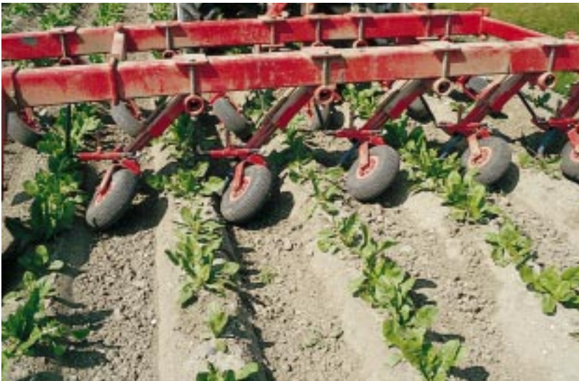
Afbeelding 10. Mechanische onkruidbestrijding met de Steketee hoekschoffel.
