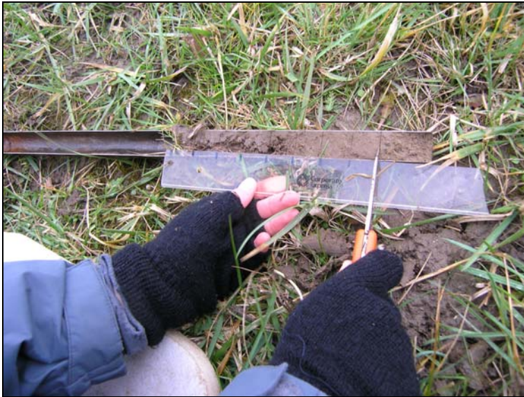
Foto 3: 'Handmethode'; de bovenste 20 cm van de wortelmonsters worden opgedeeld in stukken van 2,5 cm
