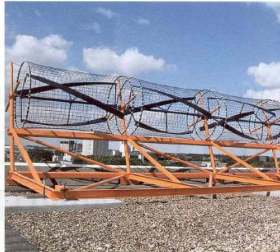
De WindWall is een ander type urban windturbine.
