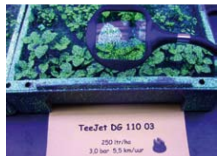
De bedekking wordt zichtbaar met fluorescerende vloeistof en blacklight
