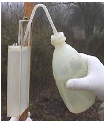
Spuitfles voor het vullen van een Nassenheiderverdamper
