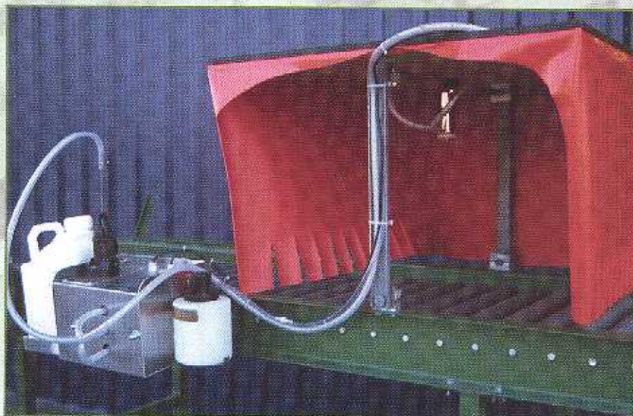
Foto 6. Correcte toepassing op rollenset geeft de hoogste bedekkingsgraad met fungicide
