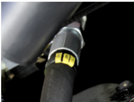
▲ Alle hydrauliekslangen zijn genummerd. Vervangen is dus eenvoudig.
