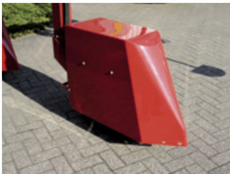
▲ Aan de polyester kappen blijven geen grond en loof hangen.
