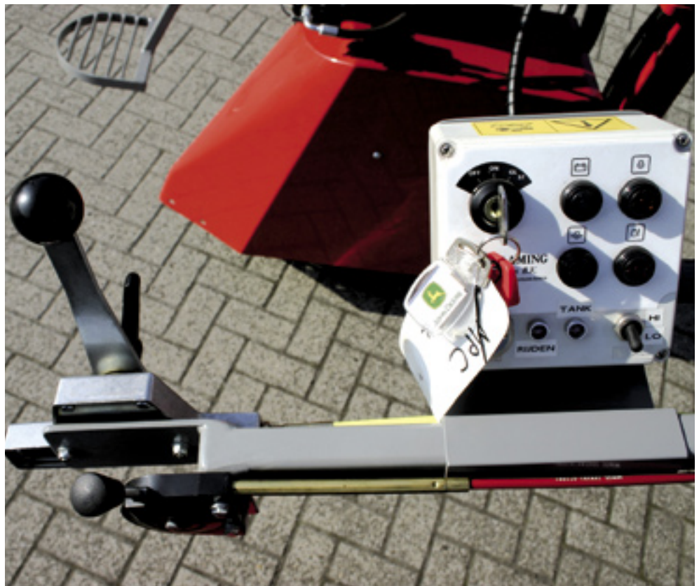
▲ De bedieningselementen: links het handgas en de rijhendel, rechts het dashboard.
